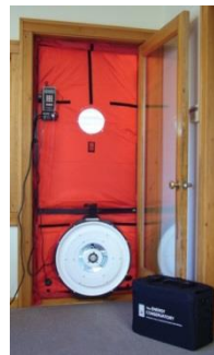
Blower Door Test
